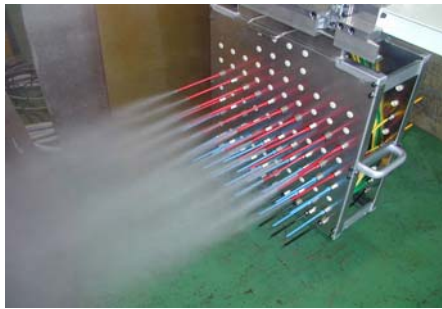
写真:11×8 パネルカセット仕様 スプレー吹付け
